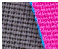
'vlakbrei' kousen zijn stugger dan rondbrei kousen
